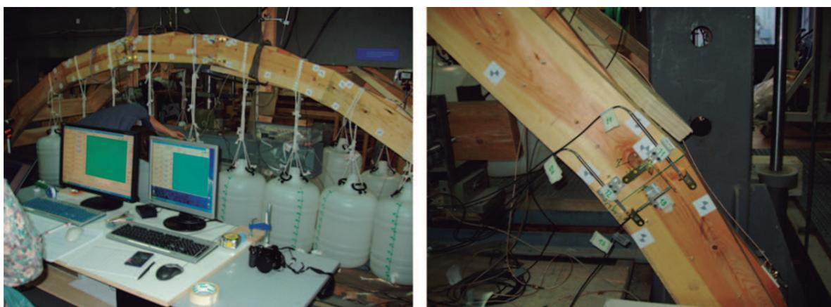
Figura 7: a) Ensayo de una sección de bóveda encamionada en escala 1:1 de 6,50 m de luz libre y 3,25 m de altura en la Universidad Politécnica de Madrid. b) Posición de los LDVT para obtener datos de desplazamientos en las uniones entre camones y luego ser llevado a un modelo matemático.
